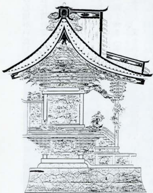
一間社流れ造の彫刻を多用した設計図
